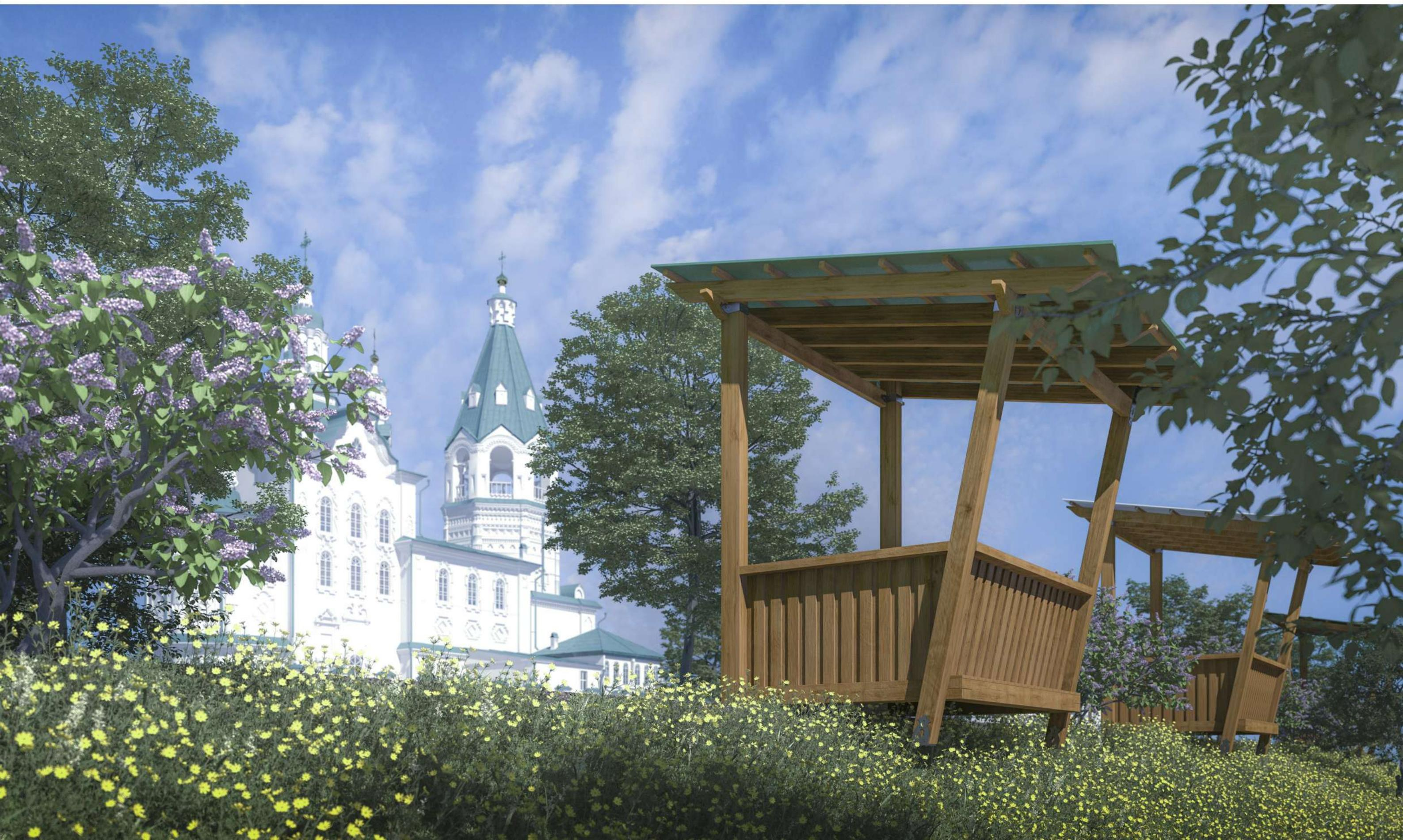
Беседка изготовлена из калиброванного бруса и доски, кровля из листового металла. Деревянные элементы скреплены декоративными накладками с просечного металла покрытого молотковой краской.
