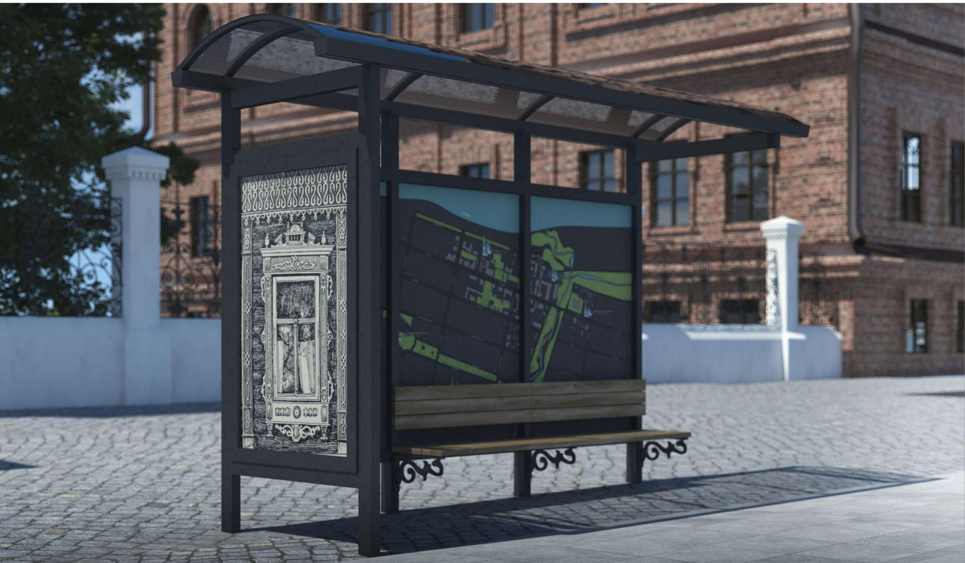
Остановка изготовлена из профилированной металлической трубы квадратного и прямоугольного сечения, каленого стекла и сотового поликарбоната. Предусмотрена встроенная лавка. Кронштейны крепления лавки выполнены из просечного железа. Все металлические элементы покрыты молотковой краской. Ламели встроенной лавки выполнены из массива хвойных пород.
